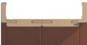
Podboji širši kot 340 mm so sestavljeni iz dveh delov!
