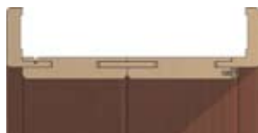
Podboji širši kot 340 mm so sestavljeni iz dveh delov!
